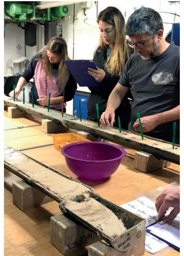
**Amostragem de sedimentos** em profundidade realizada através do lançamento de um “core” de gravidade, subindo a bordo um cilindro de sedimentos para estudo interdisciplinar
